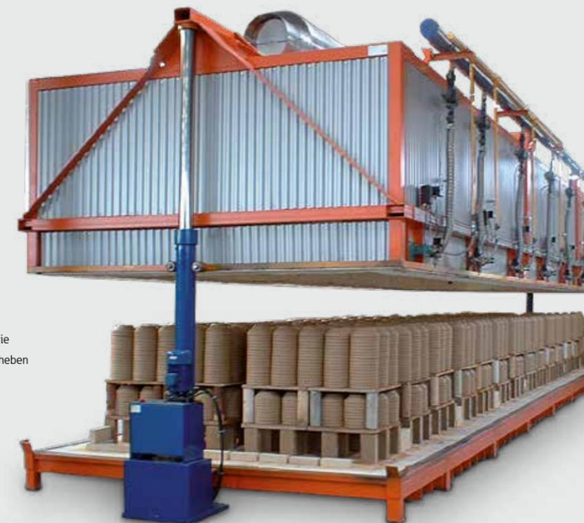
Gasbeheizte Haubenofenanlage für die Produktion von Massenware. Das Anheben der Haube erfolgt hydraulisch
