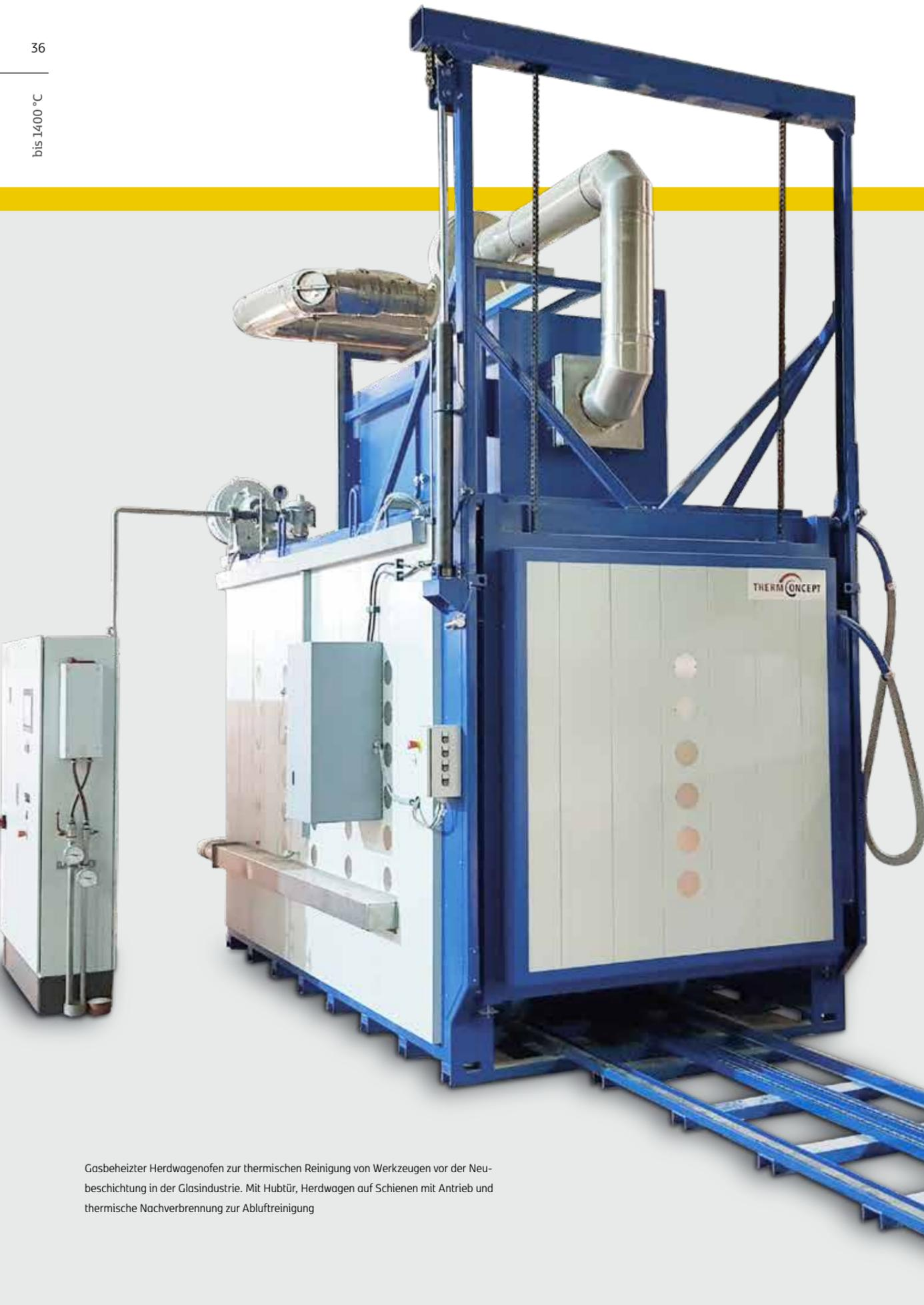
Gasbeheizter Herdwagenofen zur thermischen Reinigung von Werkzeugen vor der Neubeschichtung in der Glasindustrie. Mit Hubtür, Herdwagen auf Schienen mit Antrieb und thermische Nachverbrennung zur Abluftreinigung
