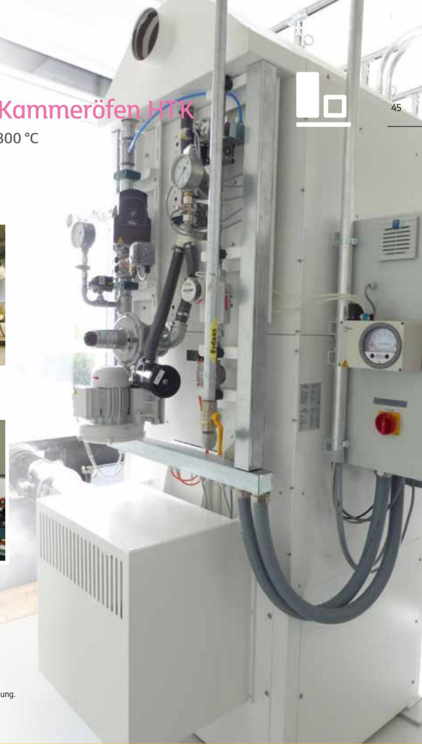
Kundenspezifischer Hochtemperatur-Kammerofen HTK mit Entbinderungssystem und optionaler Unterdruckregelung sowie gasbeheizter thermischer Nachverbrennung.
